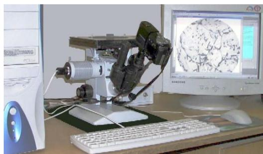
Рис. 2.19. Макроструктурный и микроструктурный анализ металлов и сплавов
