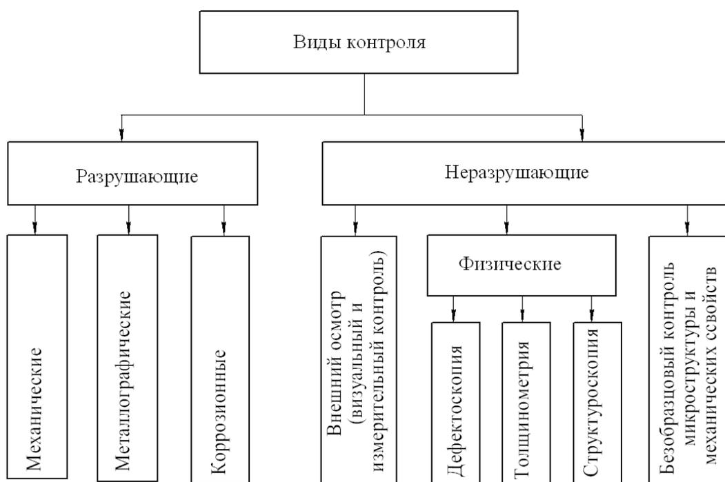
Рис.1.1. Виды контроля в зависимости от воздействия на объект контроля и влияния на его дальнейшие эксплуатационные характеристики
