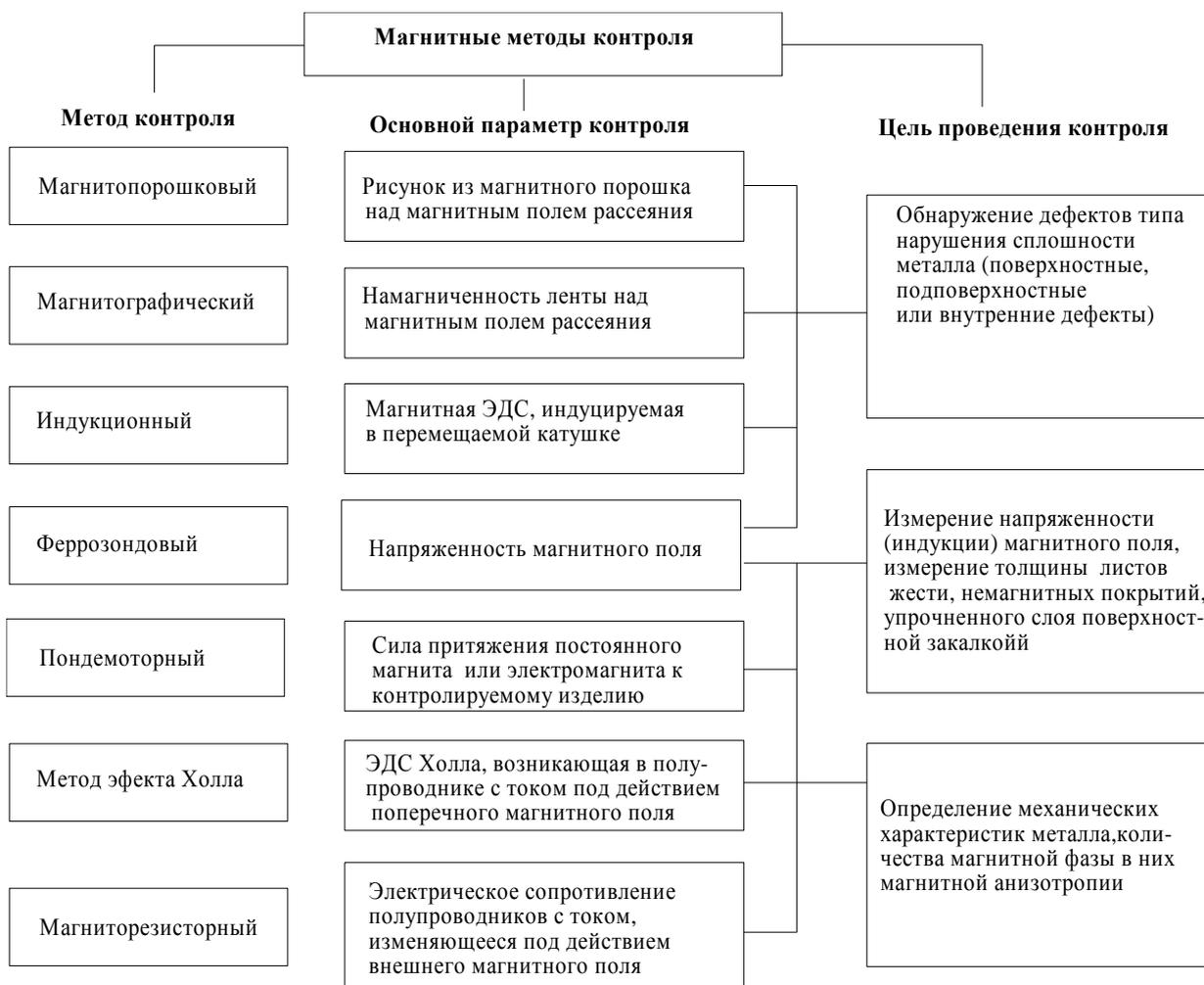
Рис.3.12. Классификация магнитных методов контроля по способам регистрации магнитных полей рассеяния
